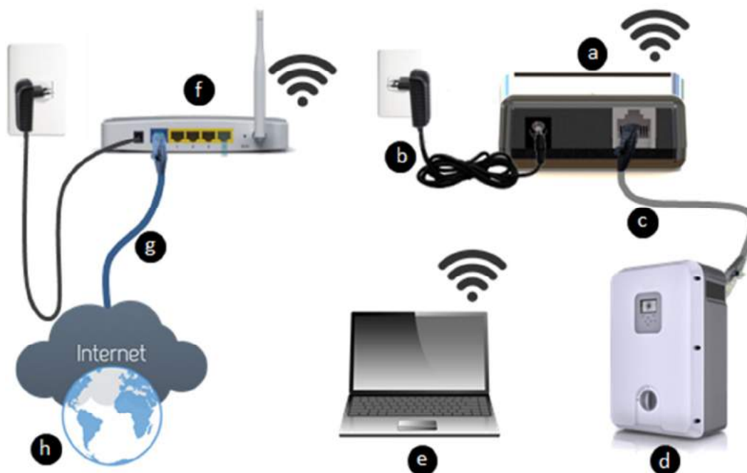
Fig.: Elementos e arquitetura para a instalação do AWC Box.
